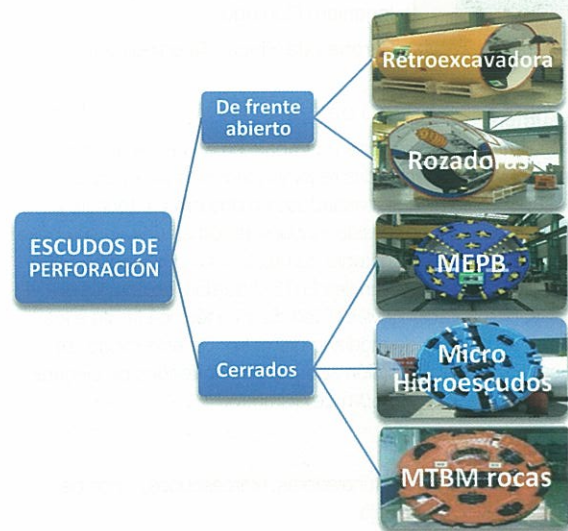
Gráfico 1. Esquema de escudos de perforación
